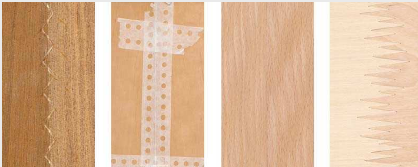
Způsoby spojení dýh – rubová strana (zleva): tavné vlákno, lepicí pásky, na tupo, podélné nastavení ozuby
