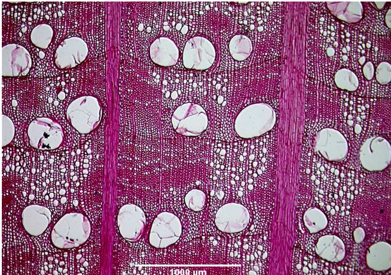
Obrázek 1: Mikroskopický snímek příčného řezu dubu
