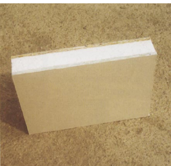
Panel Tetra K je složen ze dvou desek Tetra K2 o tloušťce 10 mm a pěnového polystyrénu.
