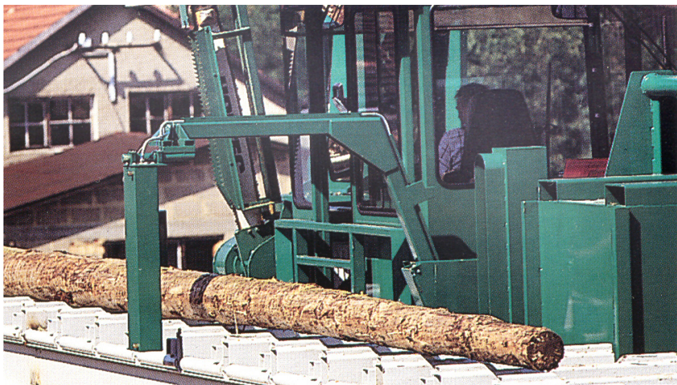
Obrázek 13 – Snímání tloušťky výřezu svislým 1D rámem. Výřez leží na pracovním stole, manipulačně třídící vozík přejíždí během měření podél celé délky výřezu. Vysílací část rámu („osvětlení“) je na výklopném rameni. (foto Baljer-Zembrod)
