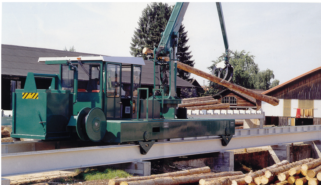
Obrázek 10 – Dráha manipulačně třídícího vozíku, provedená z “I” profilů. Stabilizační kolečka jsou umístěna zespod horní části profilu, buben napájecího kabelu je vzadu na vozíku. (foto Baljer Zembrod)
