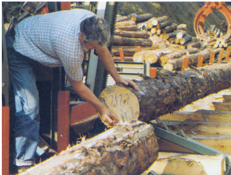
Obrázek 19 – Označování výřezů na pracovním stole po jejich nakrácení. Na čelo výřezu se obvykle píše hodnota čepové tloušťky. Značení je užitečné pro třídění a hlavně pro evidenci při pořezu na pilnici. (foto Baljer-Zembrod)
