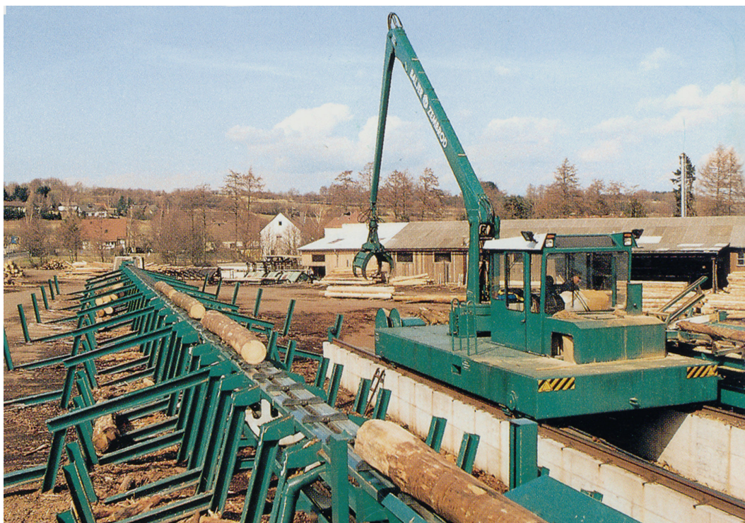
Obrázek 21 – Třídění výřezů třídícím. Vozík provádí pouze měření a krácení (pracovní stůl a zkracovací pila jsou na obrázku zcela vpravo). Výřezy jsou ukládány rukou vozíku na vstup třídíče (vpředu vpravo) ve stejném pořadí, v jakém byly vyrobeny. Třídíč je řízen počítačem vozíku. Vybírání boxů, ukládání výřezů do skládek a zásobování pilnice zabezpečuje čelní nakladač. Objem výroby v pilnici na obrázku je přibližně 45 000 m 3 výřezů ročně, pouze jehličnaté druhy dřevin. (foto Baljer-Zembrod)
