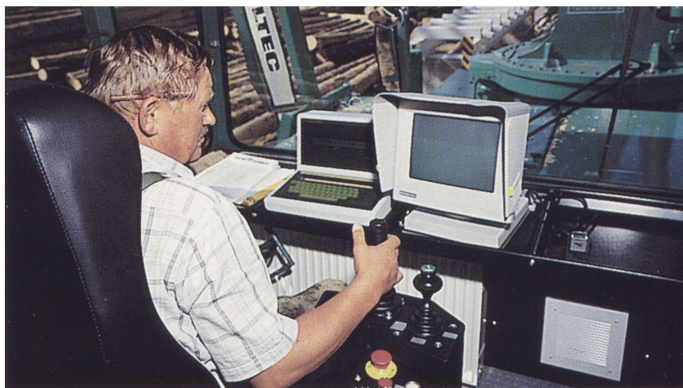
Obrázek 14 – Operátor v řídicí kabině manipulačně třídícího vozíku, vybaveného elektronickým měřicím systémem a optimalizací krácení. (foto Baljer-Zembrod)
