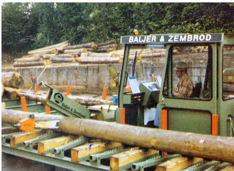
Obrázek 17 – Krácení. Kulatina je upevněna pouze krytem pilové lišty. Vybavení vhodné pro rovnou tvarově jednoduchou, převážně jehličnatou kulatinu.
