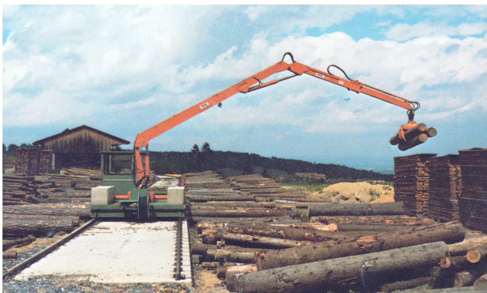
Obrázek 20 – Třídění výřezů do boxů (skládek), umístěných ve dvou řadách podél dráhy vozíku. Výřezy mohou být orientovány souběžně s dráhou nebo kolmo k ní (na obrázku). (foto Baljer-Zembrod)
