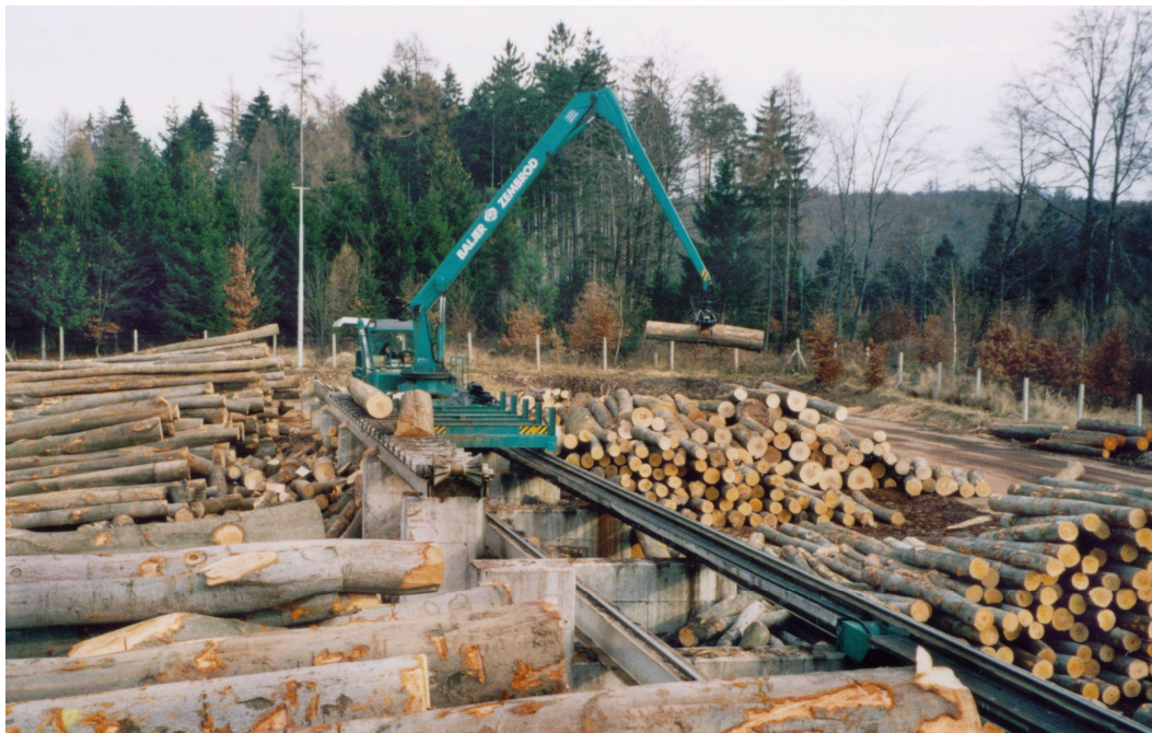
Obrázek 8 – Sklad kulatiny s objemem výroby kolem 25 000 m 3 výřezů ročně, zpracovávající převážně listnaté druhy dřevin. Sklárky kulatiny jsou vlevo, vlevo podél kolejové dráhy vozíku je pracovní stůl pro měření a krácení kulatiny. Manipulačně třídící vozík je vybaven hydraulickou rukou, měřícím zařízením a řetězovou zkracovací pilou. Boxy (sklárky) vyříděných výřezů jsou umístěny vpravo.
