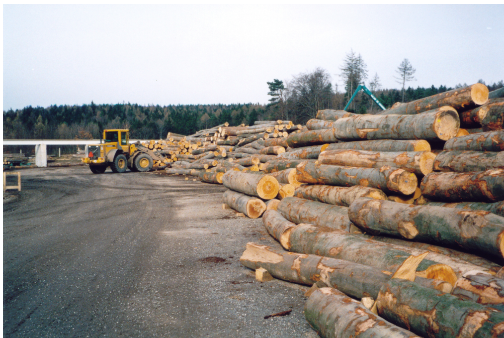
Obrázek 6 – Sklad kulatiny, obsluhovaný čelním nakladačem. Celá plocha skladu je zpevněna. Cesta podél skládek výřezů je široká asi 7 m. Čelní nakladač po ní třídí výřezy a naváží je do pilnice. Objem výroby se pohybuje kolem 10 000 m 3 výřezů ročně při dvojsměnném provozu. Zpracovávají se všechny druhy dřevin (obrázek je během listnaté sezóny).
