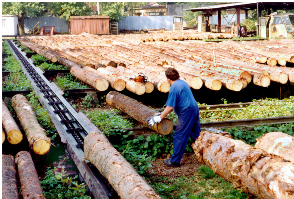
Obrázek 5 – Zásobování pilnice podélným řetězovým dopravníkem vedoucím v ose skladu podél skládek výřezů. Pracovník, který navaluje výřezy na dopravník, také odstraňuje kořenové náběhy (řetězová pila leží na výřezích ve středu obrázku). V minulosti častý způsob řešení skladu, dnes již zřídka provozovaný. Sklad kulatiny těžé pily.
