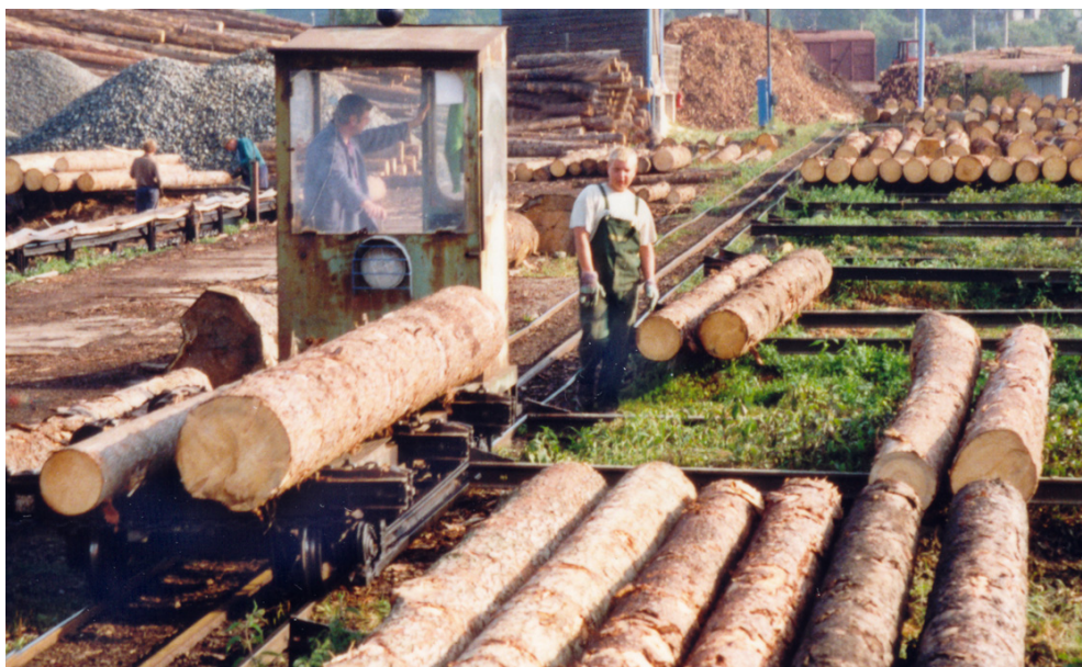
Obrázek 4 – Třídění výřezů elektrickým kolejovým vozíkem s napájením spodní trolejí (střední kolej). Vpravo jsou skládky vyříděných výřezů. Sklad kulatiny staré pily s objemem výroby kolem 40 000 m 3 kulatiny ročně, pouze smrk a borovice.
