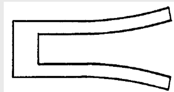
Napětí v řezivu na začátku teplotovzdušného sušení
