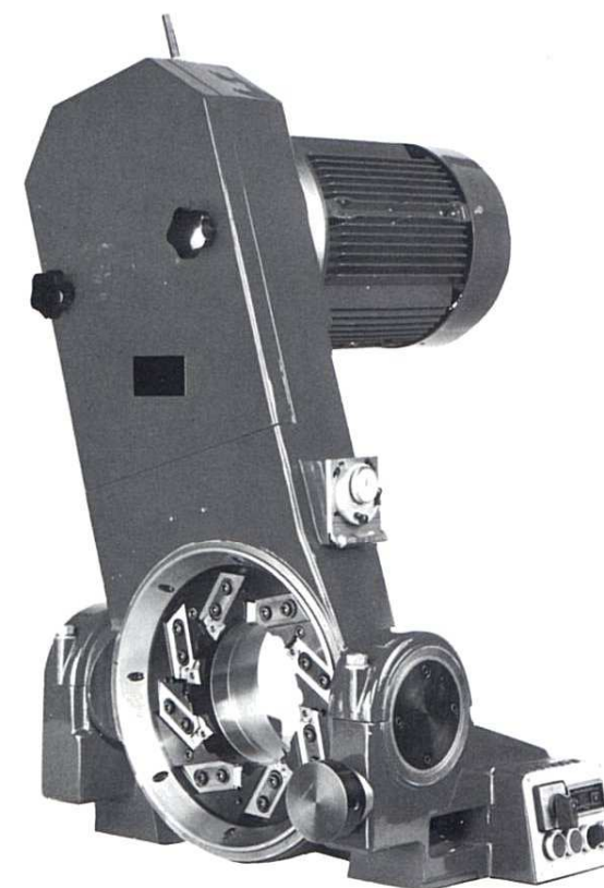
Hlava pro vnější okružní frézování na univerzálním soustruhu
