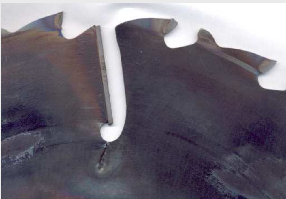
Zničený pilový kotouč pro rozmítací pilu v důsledku přehřátí, které vyvolalo ztrátu stability a jeho mechanickou destrukci.
