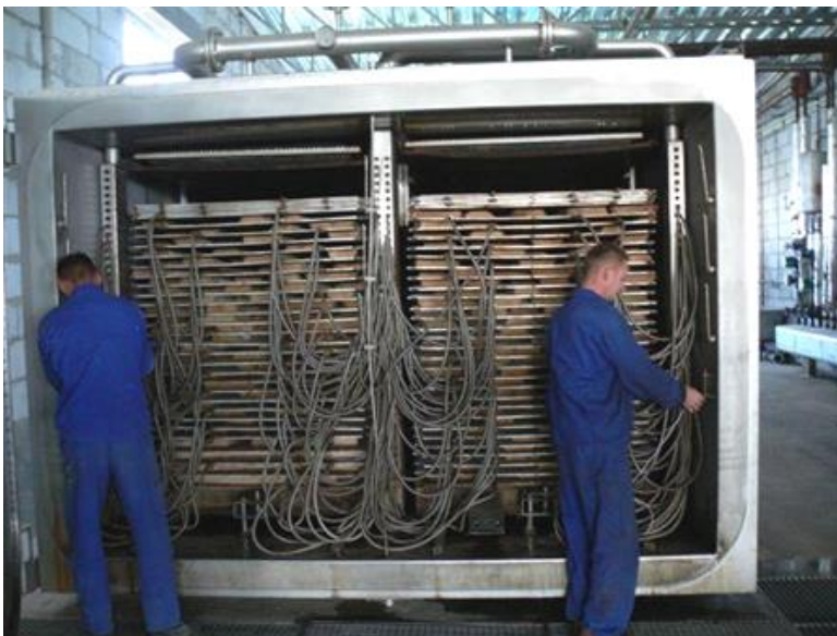
Vakuová sušárna řeziva s kontaktním ohřevem Opel
