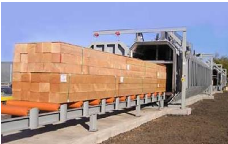
Radiofrekvenční sušárna řeziva HeatWave Drying Systems Robert Zwick
