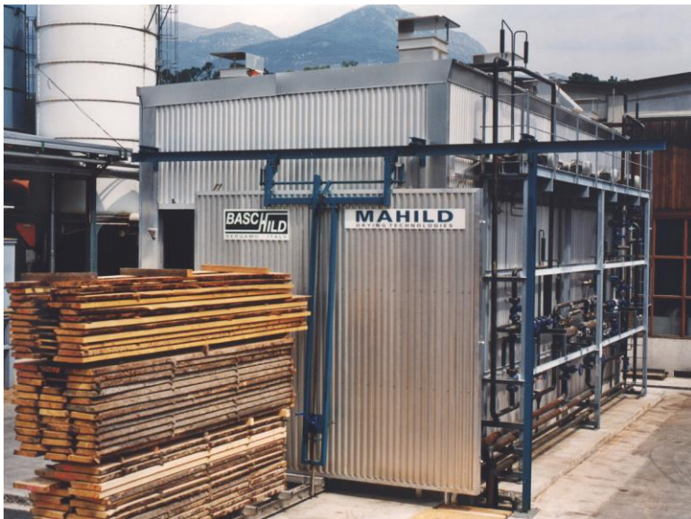
Komora pro vysokoteplotní sušení řeziva Baschild
