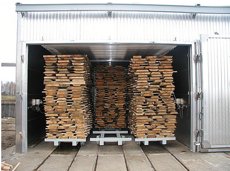
Teplovzdušná komorová sušárna řeziva Katres – zavážení pomocí kolejových vozíků
