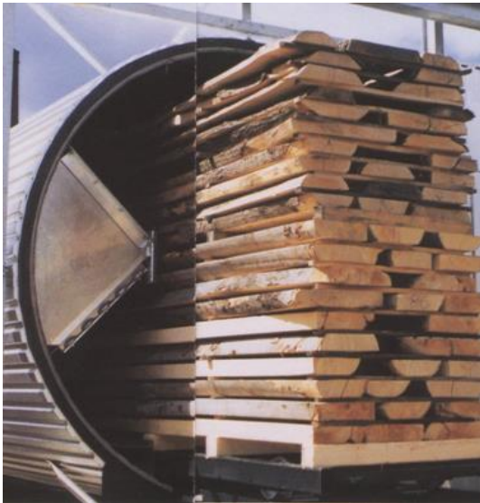
Vakuová sušárna řeziva s konvekčním ohřevem Mühlböck
