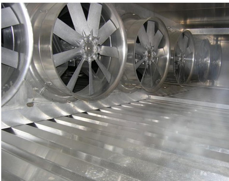
Axiální ventilátory pro konvekční ohřev řeziva (Katres)
