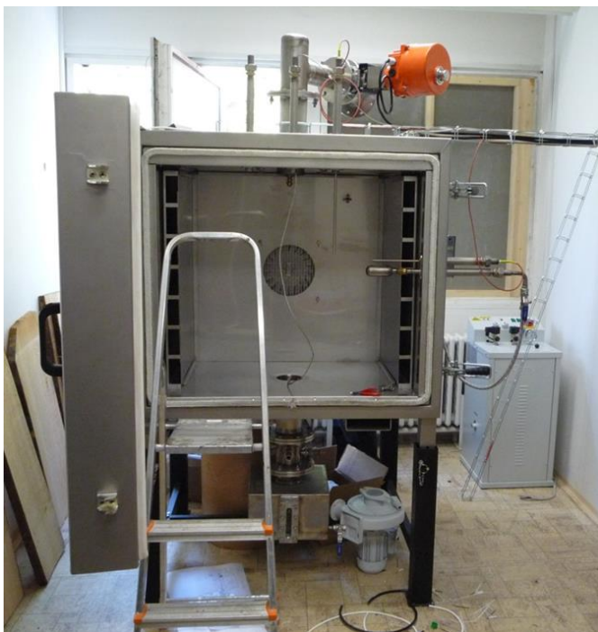
Laboratorní zařízení pro tepelnou úpravu dřeva (komora – sání, výfuk, topení, přívod páry, vlhčení, ventilace, psychrometr, sběr kondenzátu; vyvíječ páry) (Dejmal, 2015)
