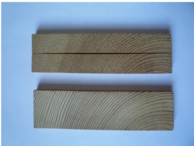
Zbytková napětí „středový řez“ (zkornatění dřeva – na povrchu tah)
