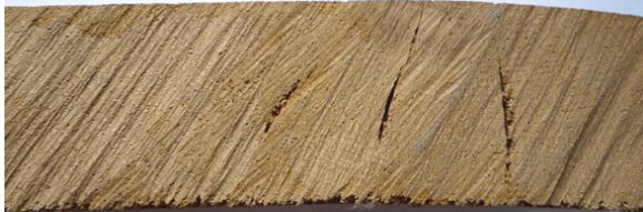
Vnitřní trhliny na příčném řezu
