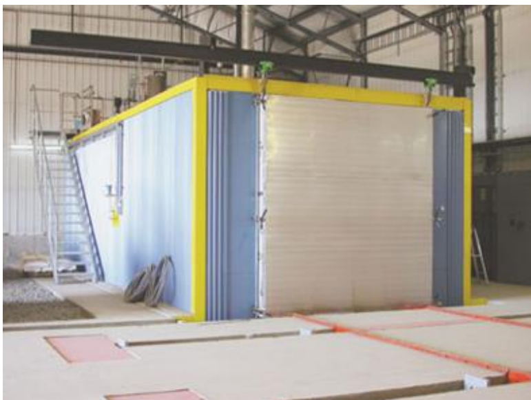
Komora pro tepelnou úpravu dřeva v atmosféře přehřáté vodní páry - Thermowood
