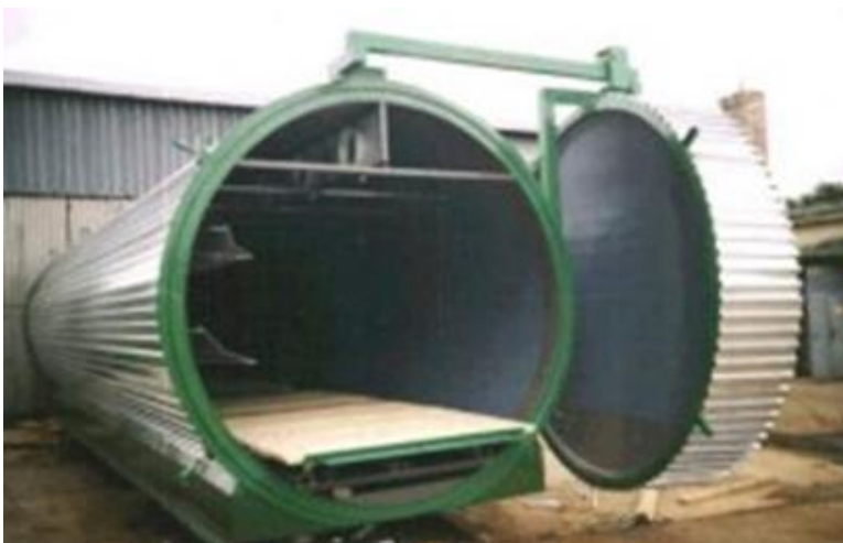
Vakuová sušárna řeziva s konvekčním ohřevem Kronseder
