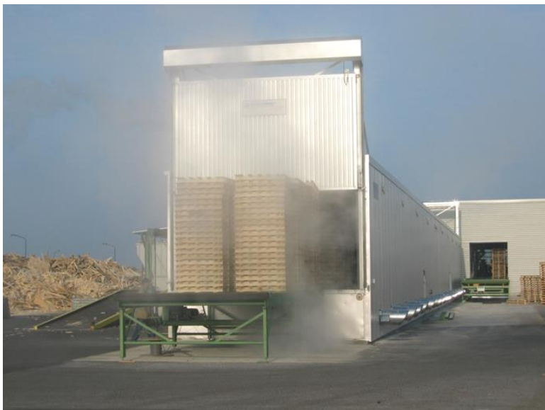
Tunelová sušárna řeziva BES Bollmann
