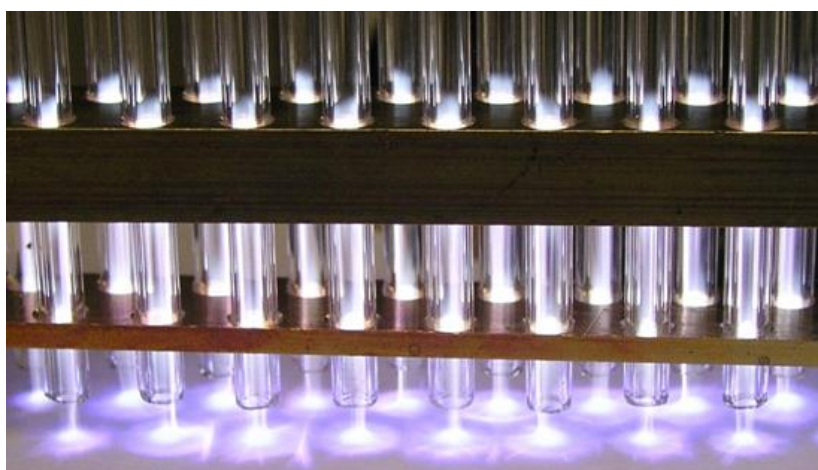
Integrovaná sestava pro úpravu ploch pomocí plazmy Klíma 2009
