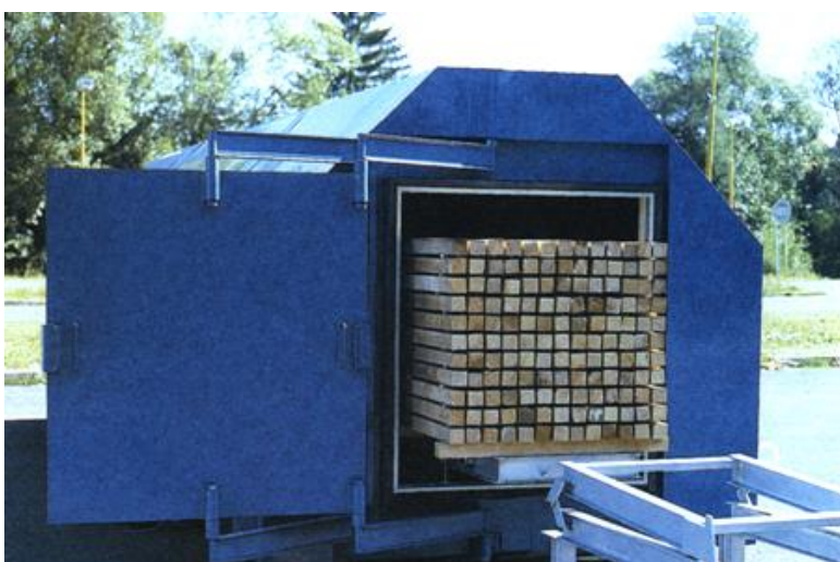
Vakuová sušárna řeziva s mikrovlnným ohřevem Woodmaster
