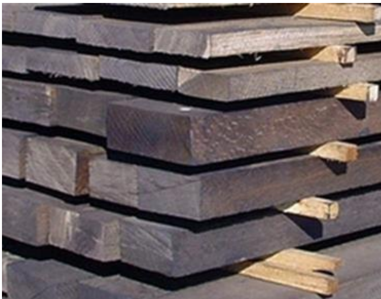
Modifikace barvy dřeva plynným amoniakem WTT
