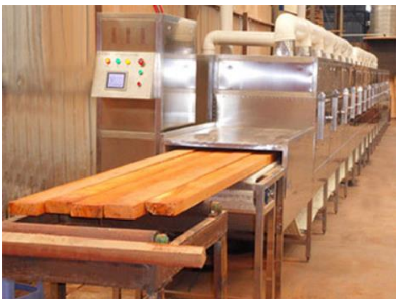
Kontinuální mikrovlnná sušárna řeziva pracující při normálním tlaku vzduchu Yantai Care Microwave
