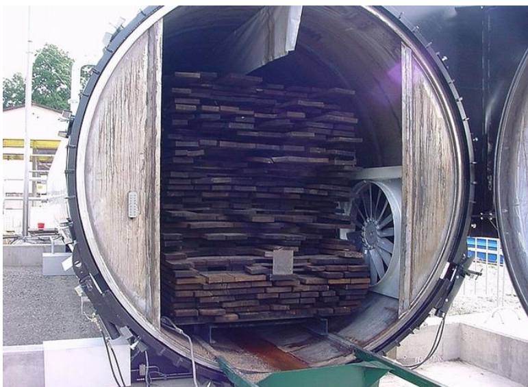
Zařízení pro modifikaci barvy dřeva plynným amoniakem - WTT
