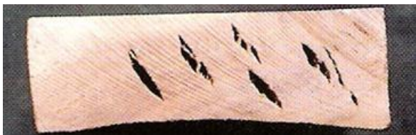
Kolaps dřeva (propadení v ploše, krátké vnitřní trhliny na příčném řezu)
