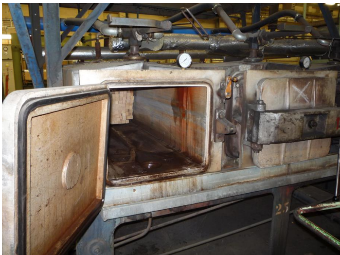
Zařízení (retorta) pro paření polotovarů před ohýbáním (lisováním)
