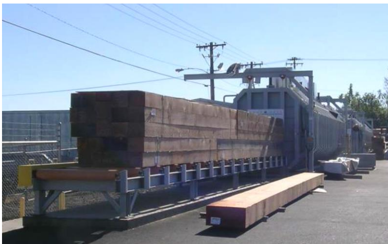
Vakuová sušárna řeziva s radiofrekvenčním ohřevem PF Inovations
