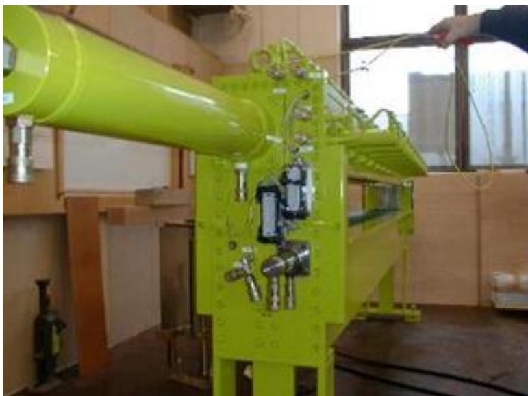
Zařízení pro lisování dřeva ve směru rovnoběžném s dřevními vlákny Compwood
