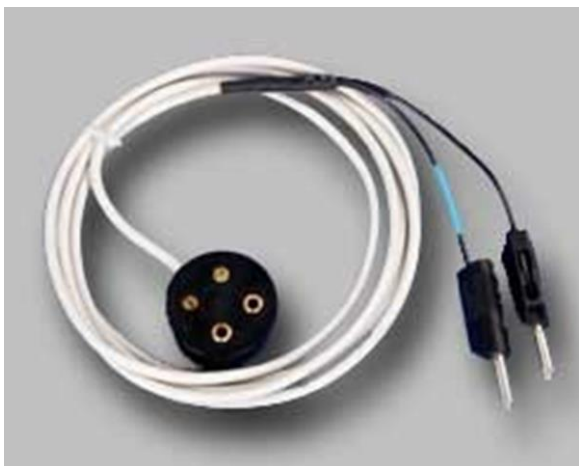
Elektrická sonda se dvěma hroty pro měření absolutní vlhkosti dřeva
