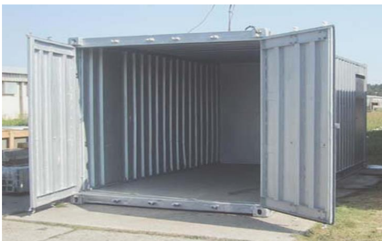
Komora na paření řeziva Katres
