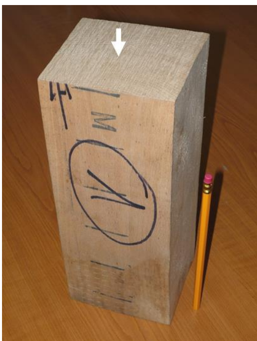
Bukové dřevo lisované ve směru rovnoběžném s dřevními vlákny Bendywood
