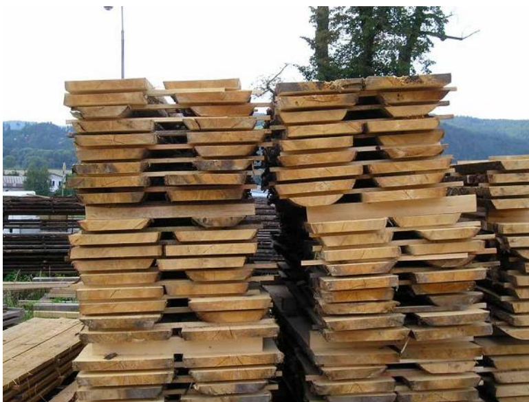
Hráň řeziva pro přirozené sušení bez zakrytí
