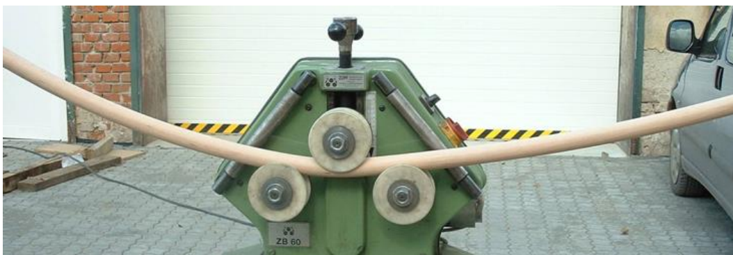
Strojní ohýbání (za studena) polotovarů většího průřezu z trvale tvárného (ohýbacího) dřeva Pergola
