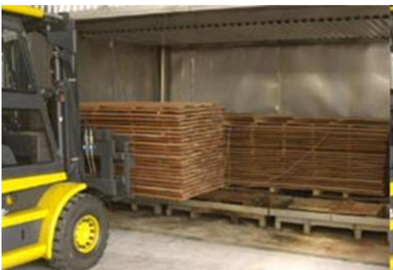
Dřevo impregnované pomocí DMDHEU Belmadur
