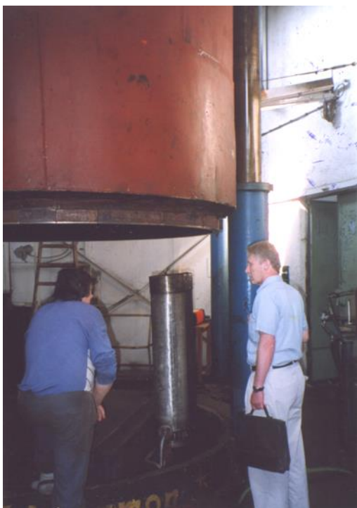
Horní část autoklávu (se zabudovaným lisem) na výrobu lisovaného dřeva Lignamon
