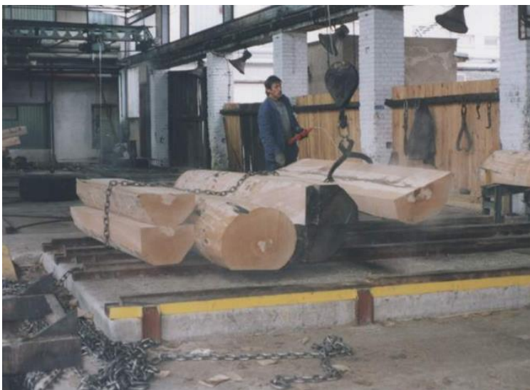
Při plastifikaci dýhárenských výřezů pařením nebo vařením dochází k eliminaci růstových napětí
