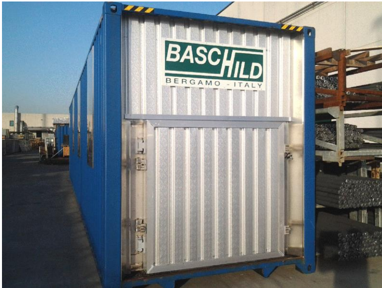
Komora pro vysokoteplotní sušení řeziva Baschild
