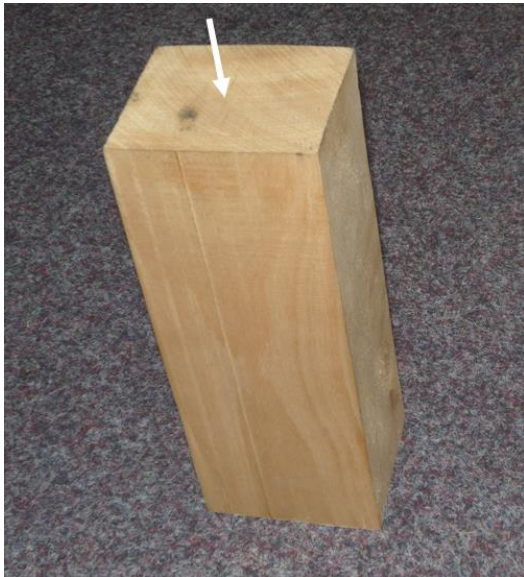
Bukové dřevo lisované ve směru rovnoběžném s dřevními vlákny Bendywood
