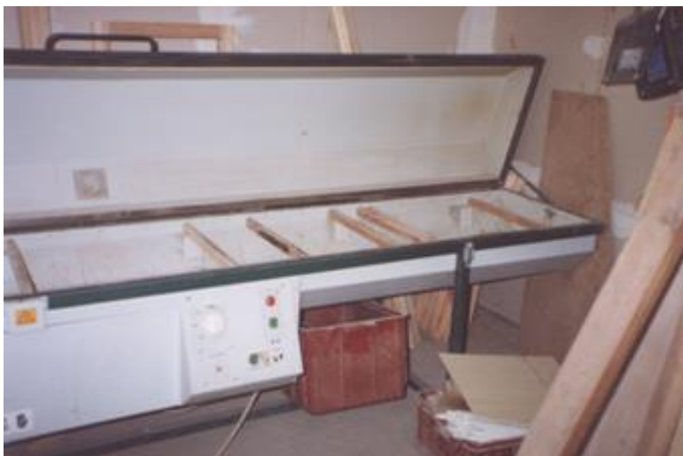
Mikrovlnná sušárna řeziva pracující při normálním tlaku vzduchu Dies
