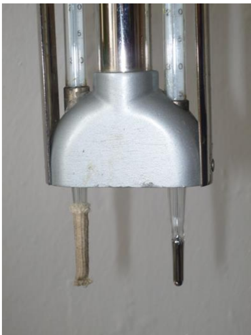
Laboratorní aspirační psychrometr pro určování relativní vlhkosti vzduchu
