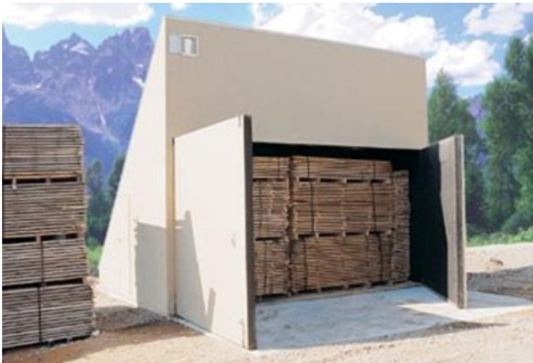
Malokapacitní solární sušárna řeziva typ „poloskleník“
