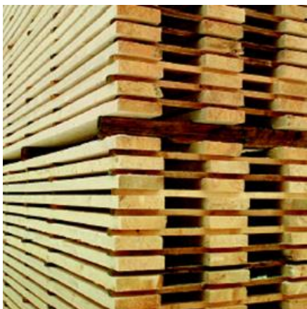
Svislé komínky uvnitř hráně řeziva - přirozené sušení
