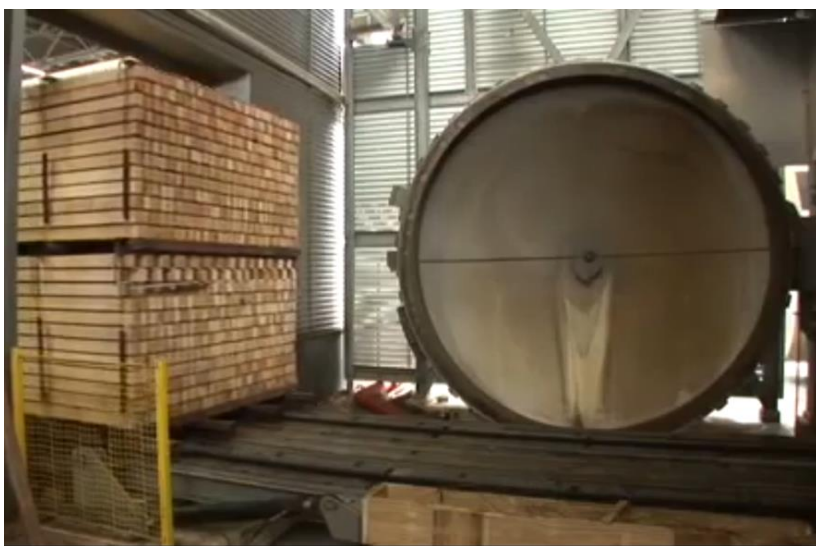
Tlaková impregnace dřeva anhydridem kyseliny octové Accoya
