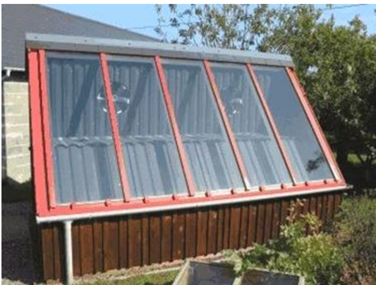
Malokapacitní solární sušárna řeziva typ „poloskleník“
