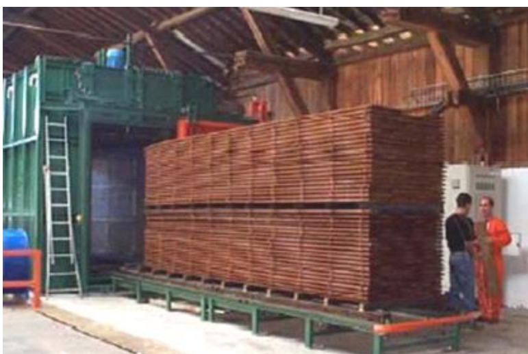
Komora pro tepelnou úpravu dřeva v atmosféře dusíku NOW - New Option Wood
