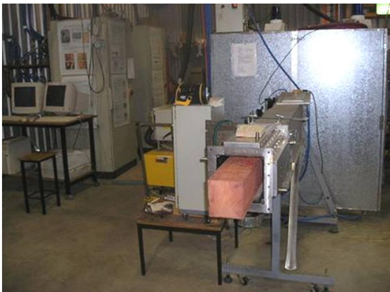
Kontinuální zařízení pro mikrovlnnou úpravu dřeva Torgovnikov 2005
