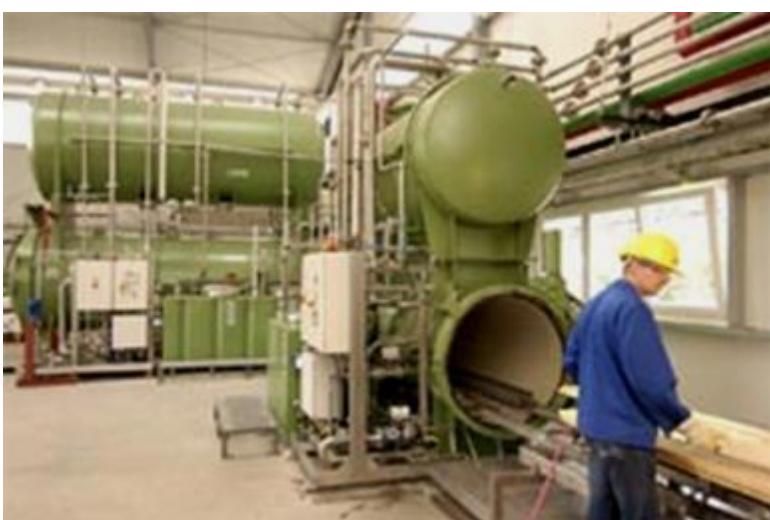
Tlaková impregnace dřeva pomocí DMDHEU Belmadur
