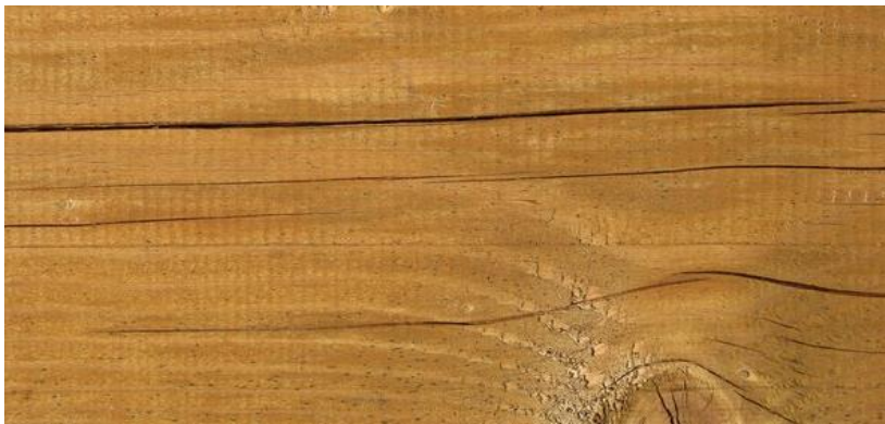
Povrchové trhliny v ploše
