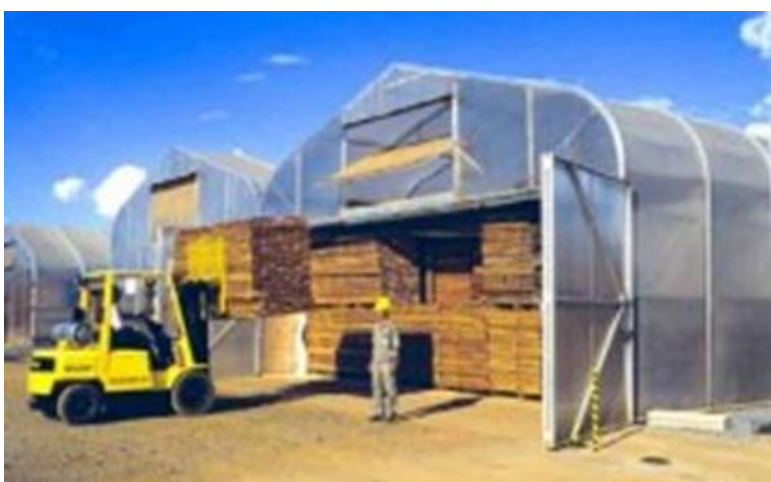
Solární sušárna řeziva typ „skleník“
