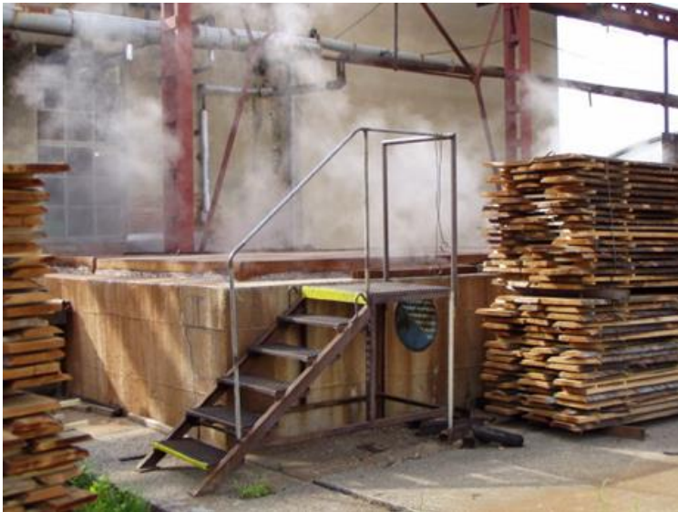
Pařicí jáma pro paření dýhárenských výřezů i řeziva
