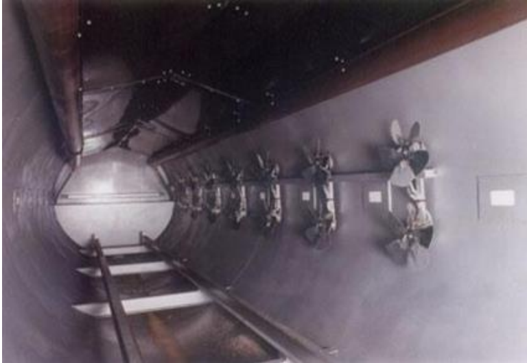
Interiér vakuové sušárny řeziva s mikrovlnným ohřevem Woodmaster
