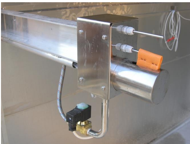
Psychrometr pro průmyslové sušárny řeziva – zařízení pomocí něhož se stanovuje relativní vlhkost a teplota sušícího prostředí (Katres)
