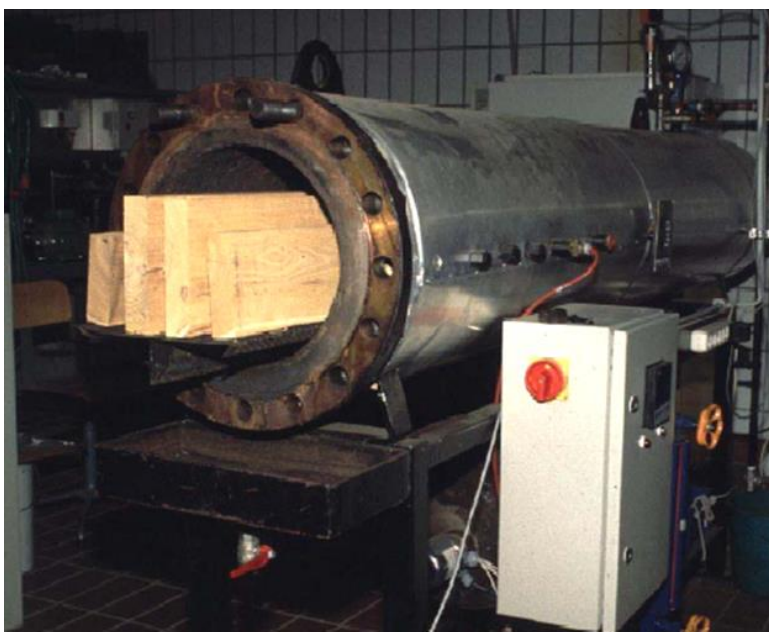
Autokláv pro modifikaci odstínu (barvy) dřeva ve vodní páře Welling
