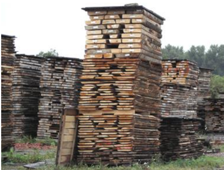
Hráň řeziva pro přirozené sušení (nevhodné uložení)
