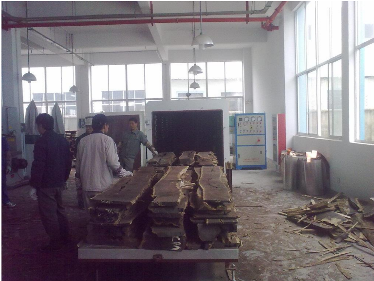
Radiofrekvenční sušárna řeziva HF Woodworking Machinery
