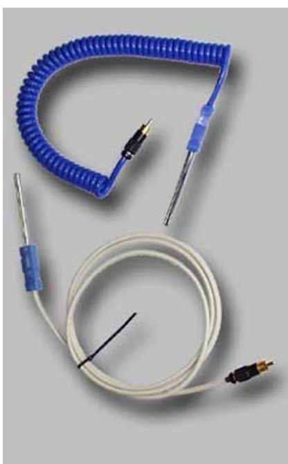
Elektrická sonda se pro měření teploty dřeva
