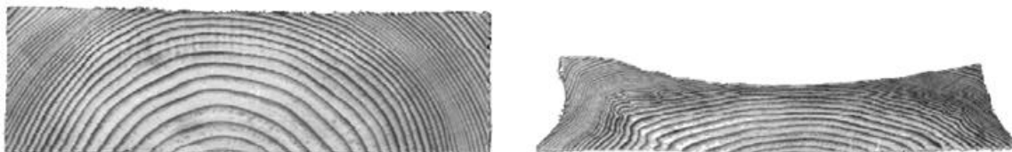
Borové dřevo lisované z různých směrů – semiizostaticky lisované Blomberg 2006
