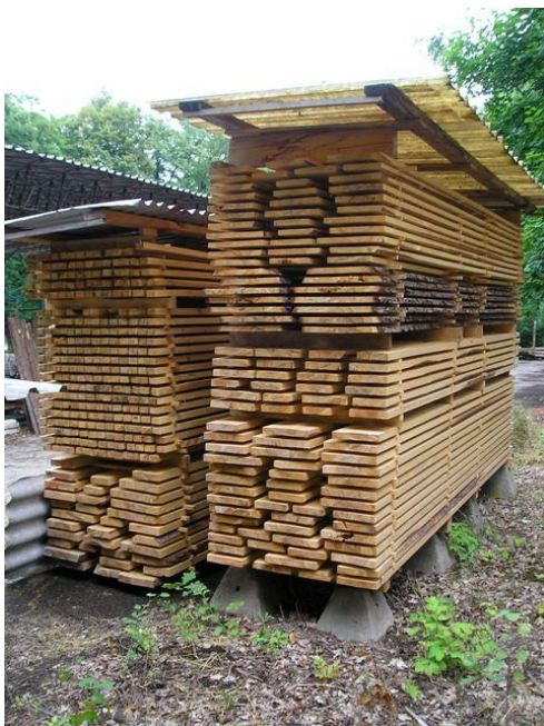
Hráň řeziva pro přirozené sušení se sklolaminátovou mobilní stříškou Harčár
