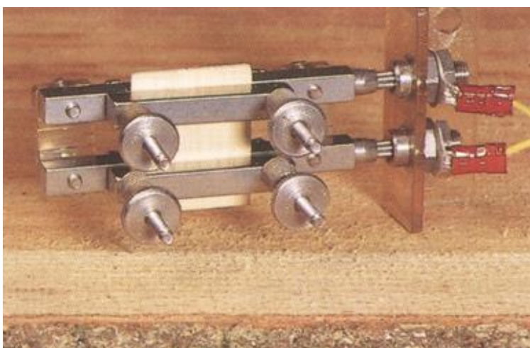
Sonda (buničínový nebo limbový pásek) pro určení vlhkosti sušícího prostředí (Mühlböck)
