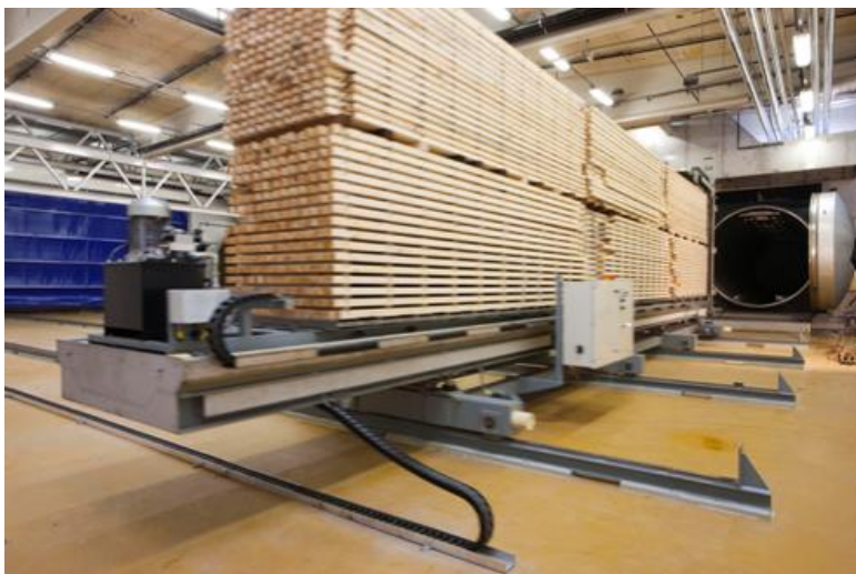
Tlaková impregnace řeziva furfurylalkoholem probíhá v autoklávu Kebony
