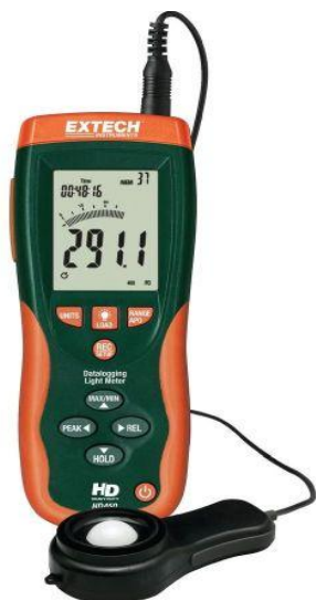
Obrázek č. 7: digitální luxmetr HD450 od firmy Extech instruments
