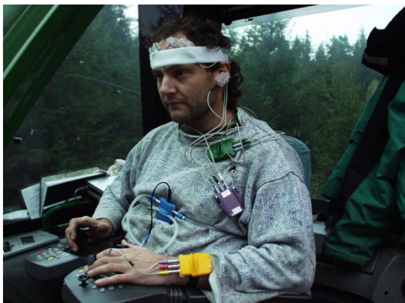
Obrázek č. 2: bezdrátové moduly se senzory a elektrodami
