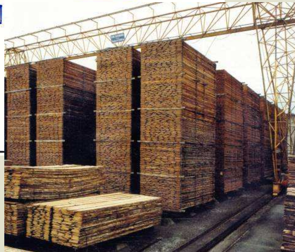
Ukládání řeziva při obsluze skladu jeřábem
