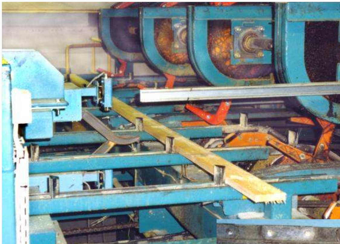
Nasouvání řeziva do podvěsných unašečů třídícího dopravníku (linky se svislými a šikmými boxy)
