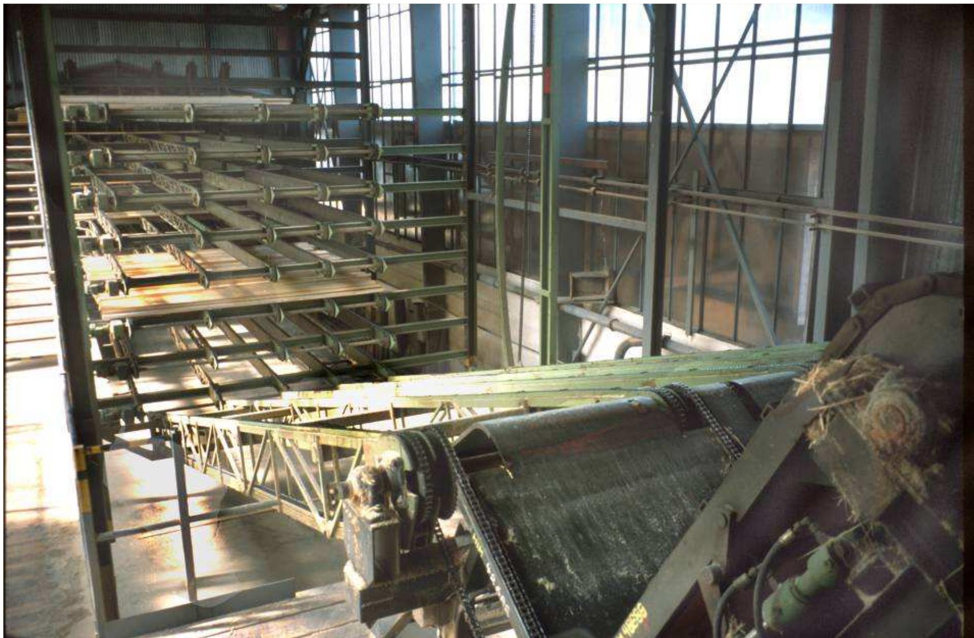
Vodorovné třídící boxy - vyprazdňování pomocí kyvného dopravníku
