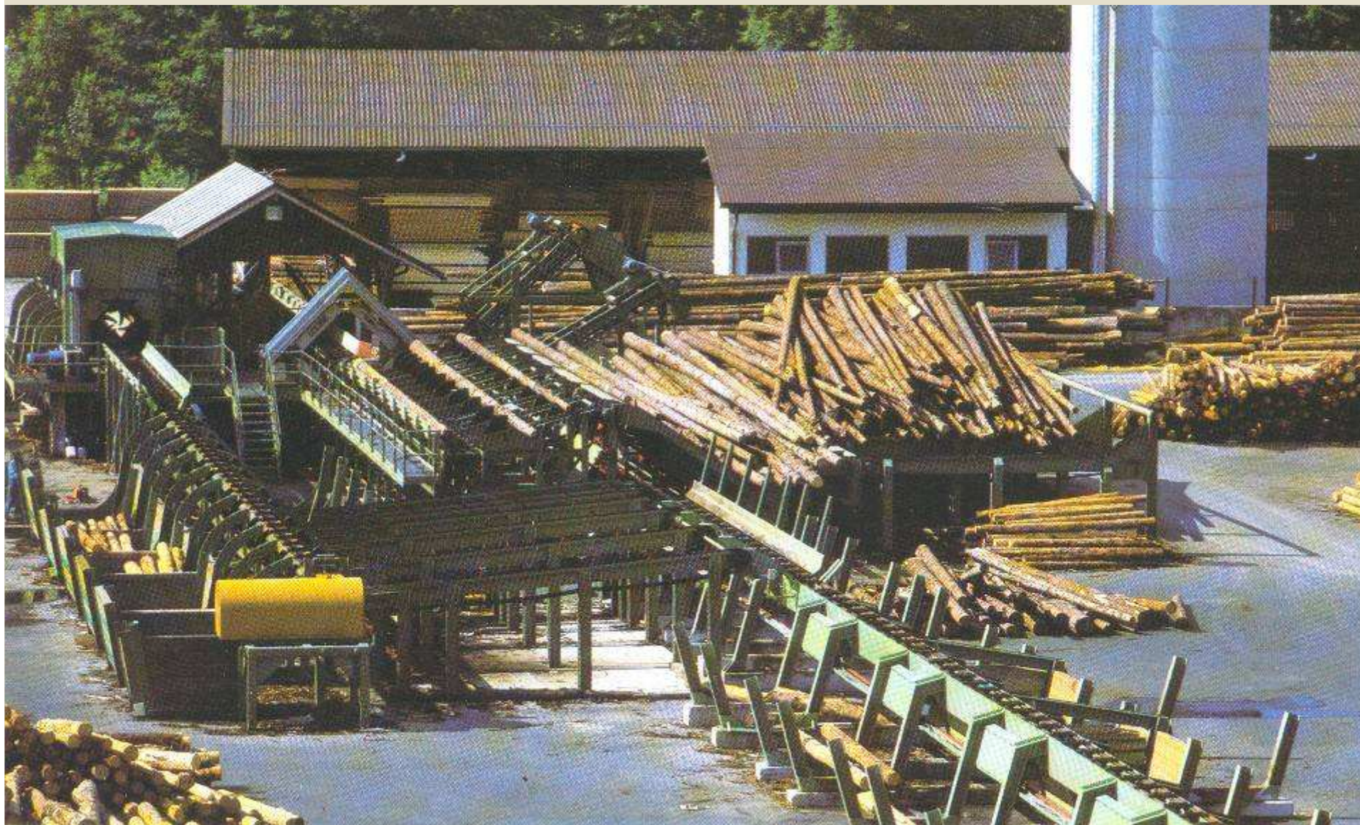
Manipulačně-třídící linka pilařského závodu, který zpracovává přibližně 60 000 m 3 jehličnaté kulatiny ročně.
