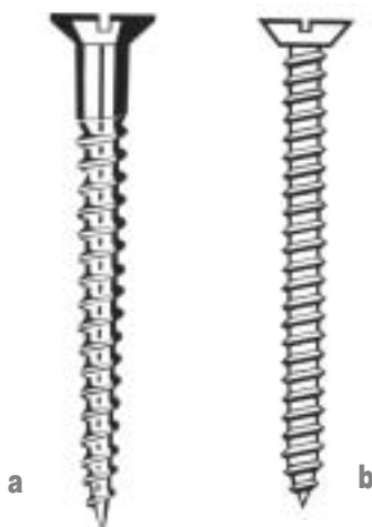
Obr. 1 a) Konvenční vruty do dřeva s kónickým dříkem b) Speciální vrut pro spojování MDF s válcovitým dříkem
